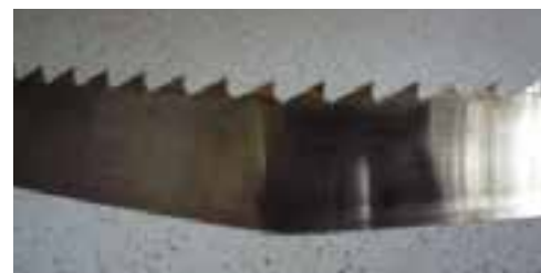
شکل ۱-۶۹- ترک پشت تیغه اره.
