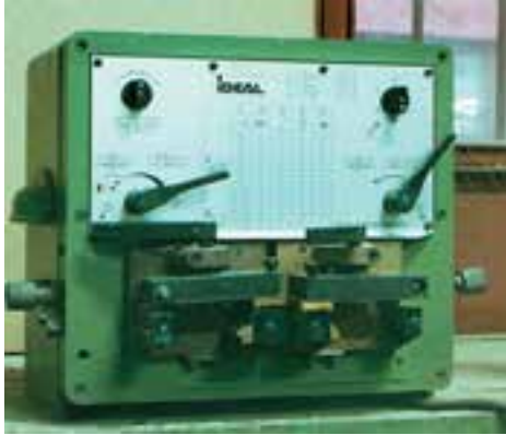
شکل ۱۲-۱- دستگاه جوش تیغه اره نواری
