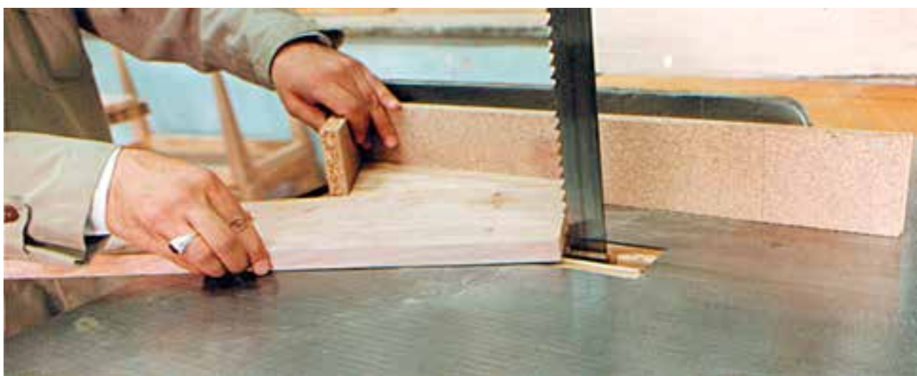
شکل ۱۵-۱- روش استفاده از شابلون برای برشهای مثلی
