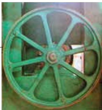
شکل ۴-۱- فلکه پایین اره نواری به همراه بانداز
