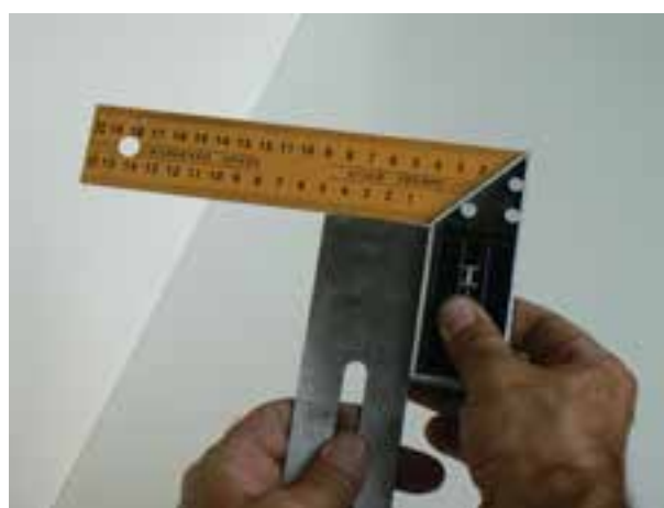
شکل ۳۳-۳ - گونمایی کردن سر تیغه رنده
