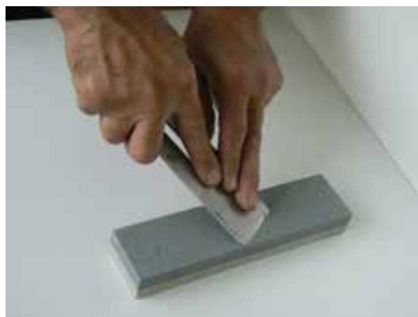
شکل ۳۴-۳ - روش سنگ نفت زدن تیغه رنده
